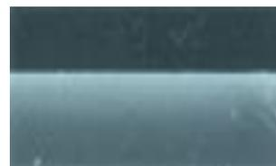
Sản phẩm bình thường bề mặt trở nên sần sùi do cặn khoáng tích tụ sau 5 năm sử dụng. Mặt cắt của sản phẩm sứ nhìn dưới kính hiển vi điện tử
